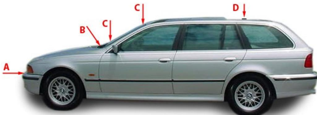
Bild 5: Mögliche Antennen-Montageorte am Beispiel eines Personewagens
